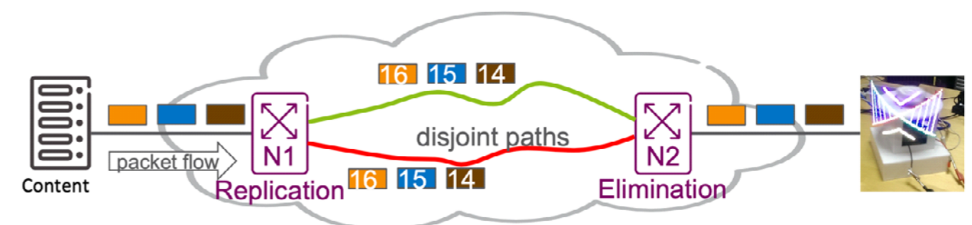
Рис. 3. Репликация, устранение и упорядочение пакетов в DetNet. 4
