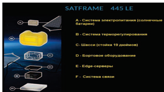
Рис. 4. Состав подсистем микро-ЦОД.
