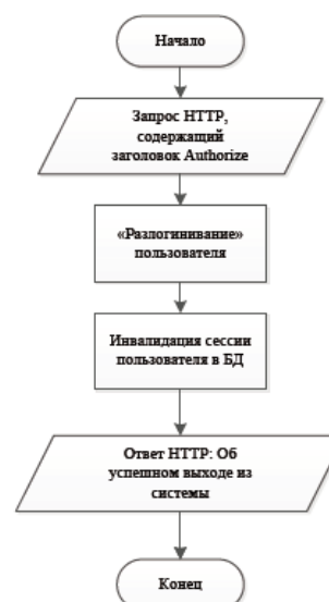
Рис. 4. Блок-схема алгоритма выхода пользователя по токenu.
