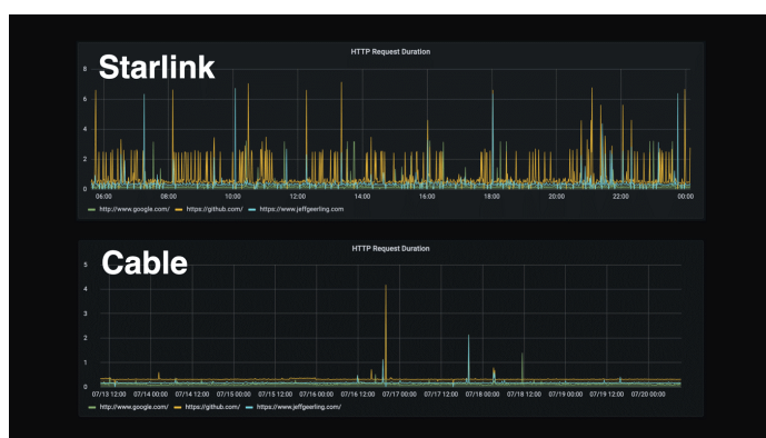
Рис. 6. Сравнение джиттера в сети Интернета «Старлинка» и в кабеле наземного провайдера.
