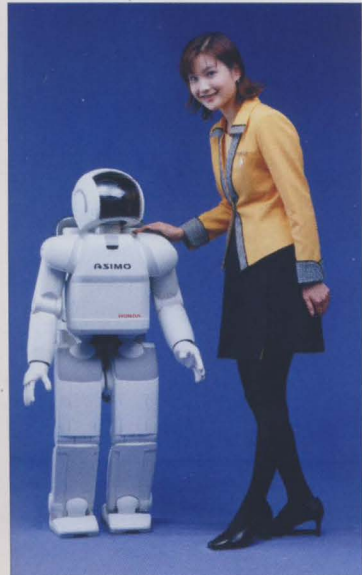
◆ На сей раз известный робот ASIMO, созданный North American Honda Group, продемонстрировал на выставке новые способности: теперь он не только ходит по горизонтальным, наклонным поверхностям и лестницам; он еще и бегает, не теряя равновесия! Пока со скоростью всего 6 км/ч, но все-таки...
