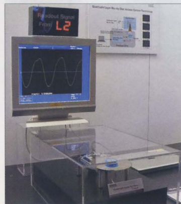
◆ Специалисты Hitachi устроили на выставке настоящее шоу, демонстрируя, как обычный серийный Blu-ray-привод читает... четырехслойный диск Blu-ray емкостью 25 Гбайт данных на слой
