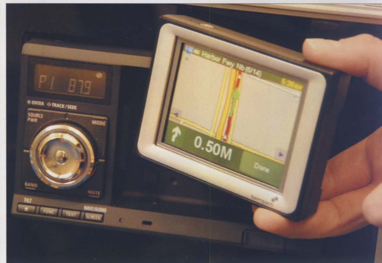
◆ Автомобильная навигационная система AVN2210p от Eclipse Car Audio & Navigation: компактный экран отделяется от системы и позволяет при необходимости выйти из машины, добраться до труднодоступной точки маршрута на своих двоих
