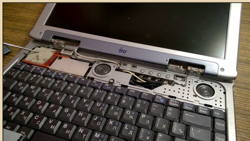
Рис. 2. Обслуживание ноутбука iRU, купленного всего за 200 (двести) рублей. Особенность этой модели – процессор Transmeta Crusoe 4 , эмулирующий команды x86
